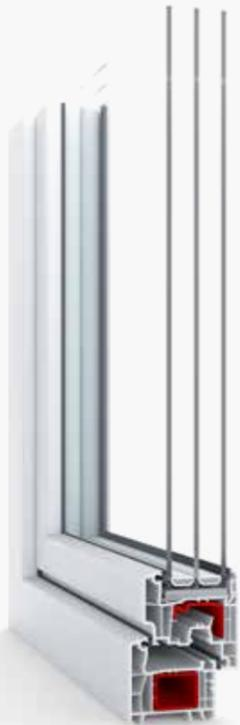
In der Konfiguration mit dem neuen halbflächenbündigen Flügel, mit der Option der Verglasung mit 48 mm breiten Scheibenpaketen, ist es möglich, noch wärmere Fensterkonstruktionen (bis zu  $U_w=0,85 \text{ W/m}^2\text{K}$ ) im System IDEAL 4000 zu schaffen.
